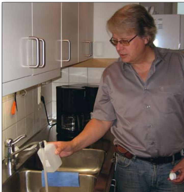
Legionellabakterien kan överleva i kallt vatten men börjar inte sig förrän temperaturen är 20 - 40 grader. Därför är det viktigt att varmvattentemperaturen håller minst 50 grader.
